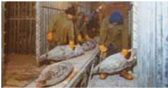
焼津工場での冷凍マグロの入庫スラットコンベアを使用し1尾ずつ積み上げていた。
