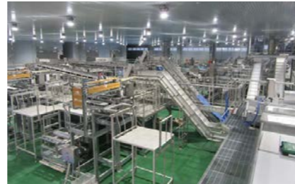
気仙沼ソーティングスポットⅡの自動選別凍結ライン
