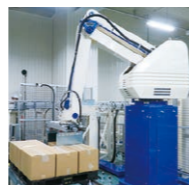
作業用ロボットを使用したデバンパレタイズシステム（DPS）を導入
